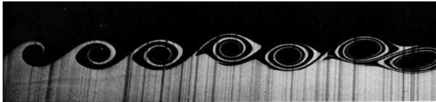
Figure 1.14 : Instabilités de Kelvin Helmholtz dans un écoulement cisailé (Van Dyke, 1988)
