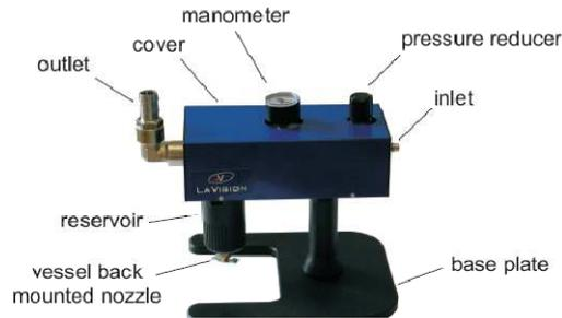
Figure 3.13 : Générateur de particule LaVision utilisé pour les mesures PIV en air
