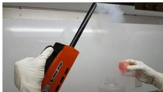
Smoke test utilisé pour étudier les flux laminaires
