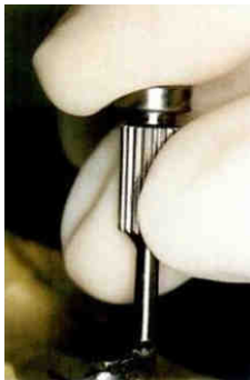
Fig.27 : Tournevis de type horloger ; la virole permet de continuer à appuyer sur la vis tout en manipulant le manche. [Bert, 12]
