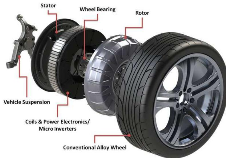
Figure 3: Constitution du moteur-roue électrique développé par la société Protean [7]
