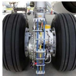
(b) Roue motrice du train d'atterrissage fabriqué par Messier-Bugatti-Dowty
