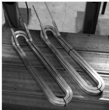
**Figure 7: Bobinages refroidies par liquide[18]**
