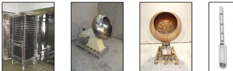
**Figure 5 : Photographies d'anciens équipements utilisés dans l'industrie pharmaceutique, de gauche à droite : une étagère à plateaux, deux turbines boules de Pelliculage et un pèse sirop.**
