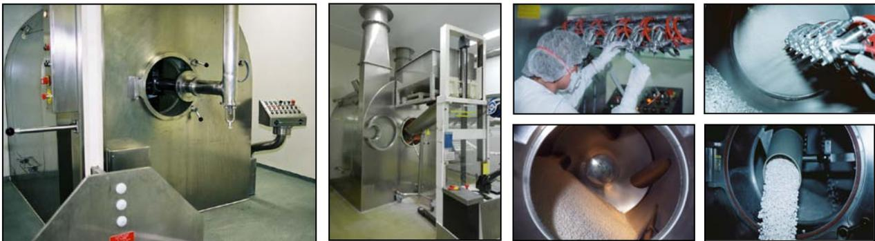
**Figure 44 : Photographies des étapes de chargement, de réglage, de préchauffage, de pelliculage et de déchargement d'une turbine de pelliculage**
