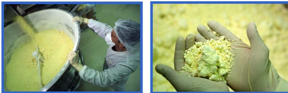
**Figure 28 : Photographies de la cuve à matière d'un LAF contenant du grain de Maxilase® à gauche et du grain de Maxilase® à droite**
