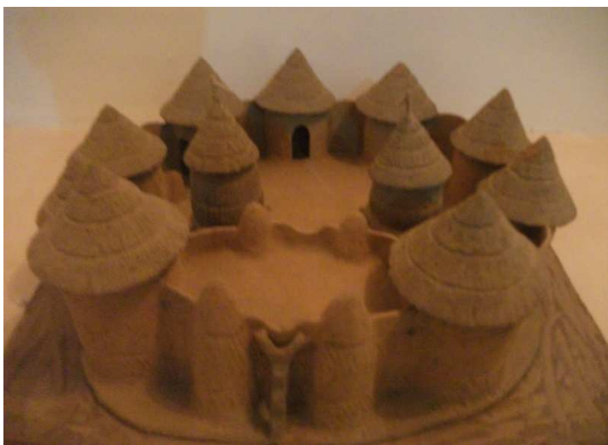
Photo 38: Maquette d'un tata berba présent à Matéri. Le complexe ne dispose pas de porte d'entrée mais plutôt d'une échelle pour éviter les attaques des animaux sauvages qui rodent souvent (Photo P. Akogni)
