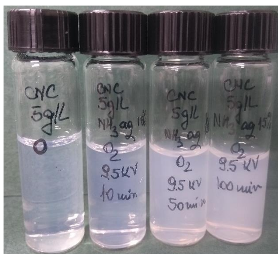
Figure 104: Photo NCC dispersés dans NH 3 aq avant et après traitement plasma sous O 2
