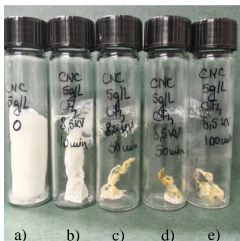
Figure 108: Photo NCC lyophilisés: a) non traités; b) après 10 minutes de traitement ; c) après 30 minutes de traitement ; d) après 50 minutes de traitement; e) après 100 minutes de traitement sous CF 4 à 8.5 kV
