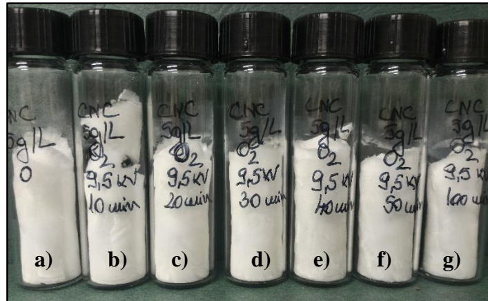
Figure 67: NCC avant (a) après (b) 10 min (c) 20 min (d) 30 min (e) 40 min (f) 50 min (g) 100 min de traitement plasma sous O 2 et lyophilisation
