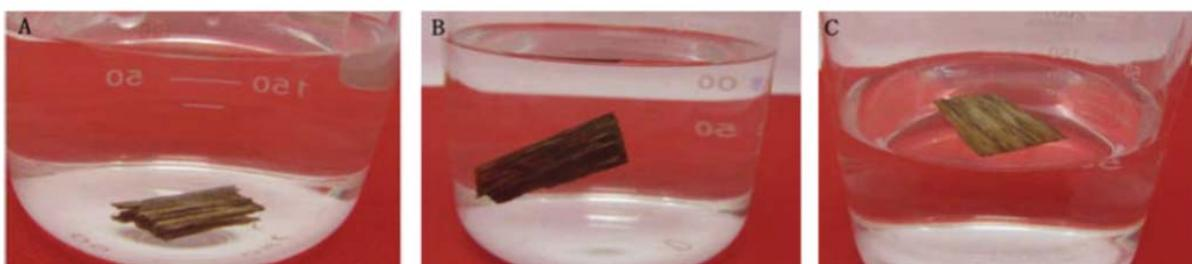
Figure 29 - Détermination de la qualité du bois d'Agar suivant son degré de flottaison (A : non flottant, chargé de résine, B : bois flottant à moitié, contenant une quantité moyenne de résine, C : flottant, contenant peu ou pas de résine) [66]
