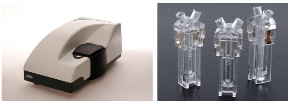
Figure 41 : Illustration du Zetasizer Nano ZS et des cuvettes de mesure
