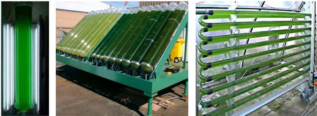
**Figure 9 : Photobioréacteurs de type tubulaire (scobalite, monotubulaire, multitubulaire)**
