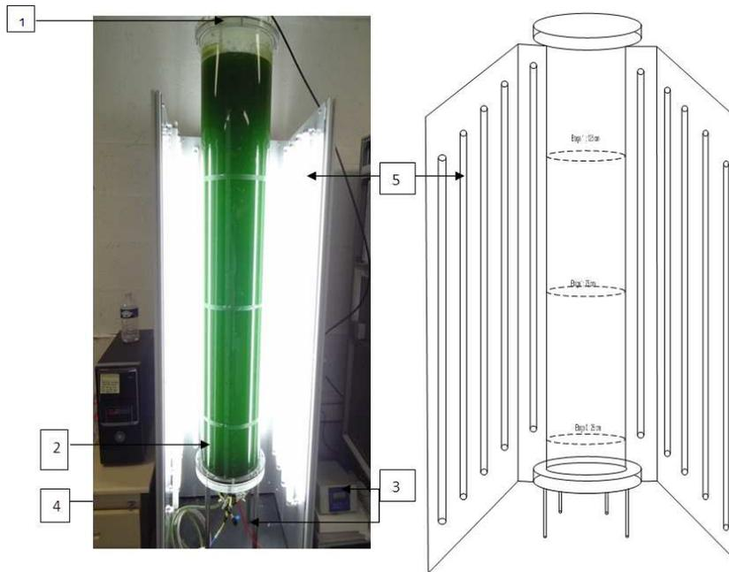
**Figure 31 : Schéma expérimental du PBR scobalite**
