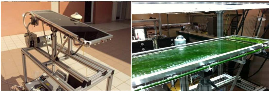
Figure 11 : Photobioréacteur à écoulement en film (AlgoFilm)
