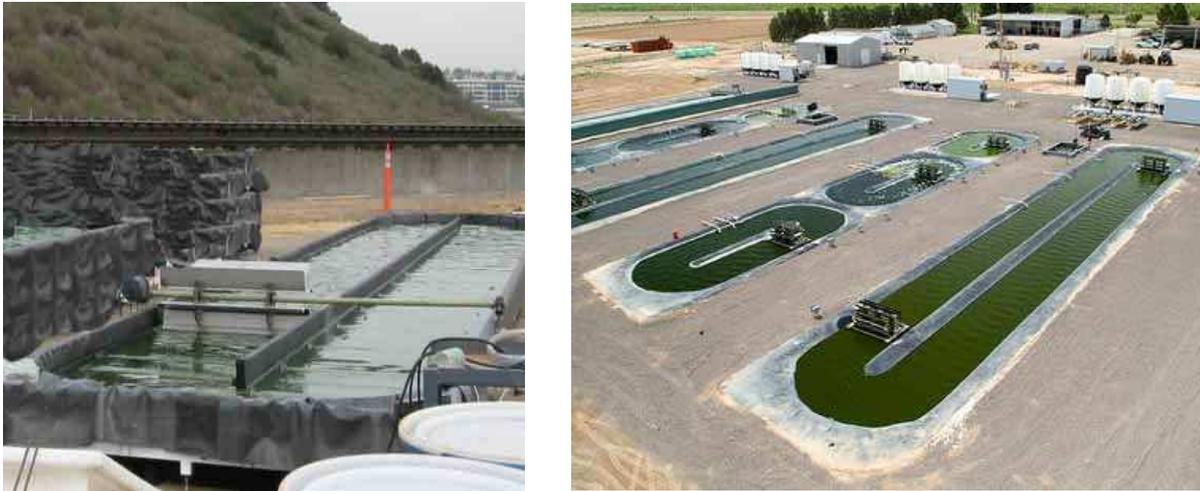
Figure 8 : Exemple de réacteur ouvert de type champ de course (raceway)
