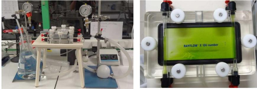
Figure 44 : Montage expérimental du module de filtration tangentielle Rayflow
