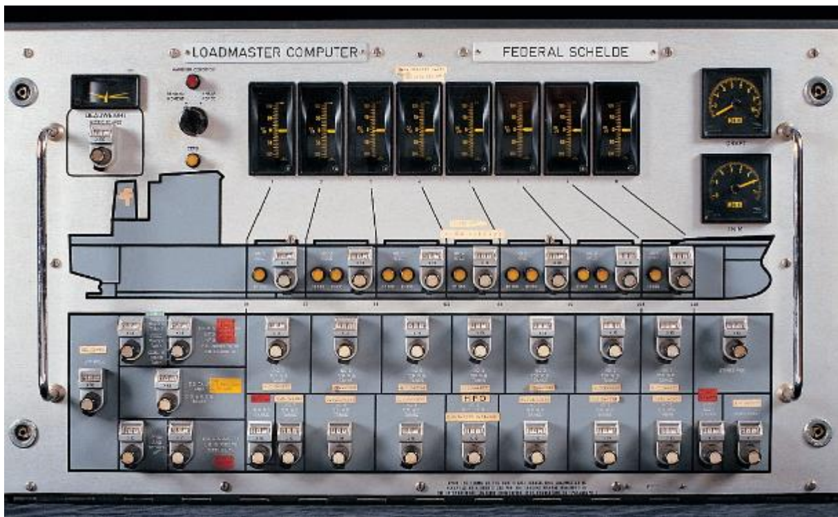
Figure 63 - Calculateur de chargement analogique type Loadmaster (1977) Kockums Automation AB Marine, Malmö- Museum aan de Stroom, Anvers
