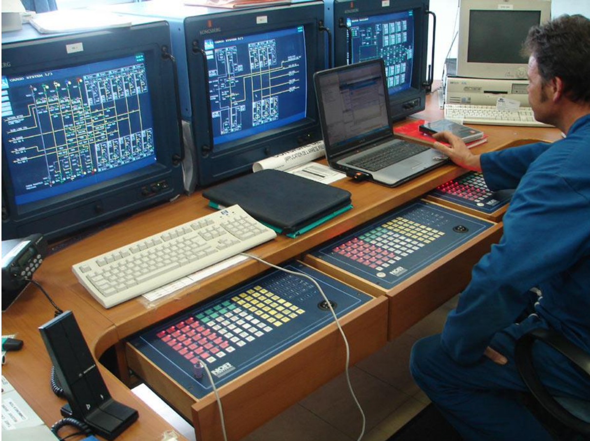
Figure 62 - Officier de quart au PC cargo d'un navire pétro-chimiquier (2006) source : Hervé Cozanet
