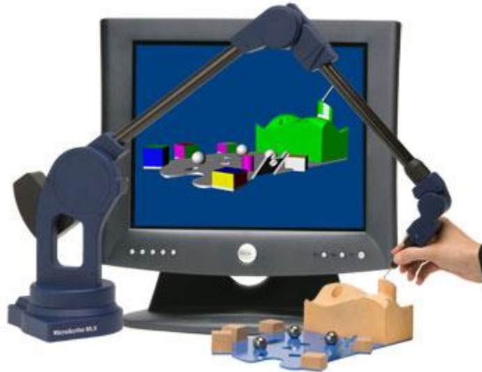
Figure 18 : numérisation 3D avec bras de palpation (d'après le site internet : http://www.numerisation-3d.info/ )
