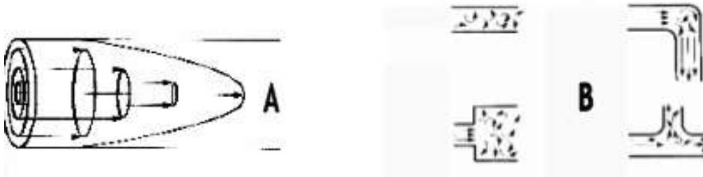
Figure 14 : écoulement laminaire (A) et écoulement turbulent (B)
