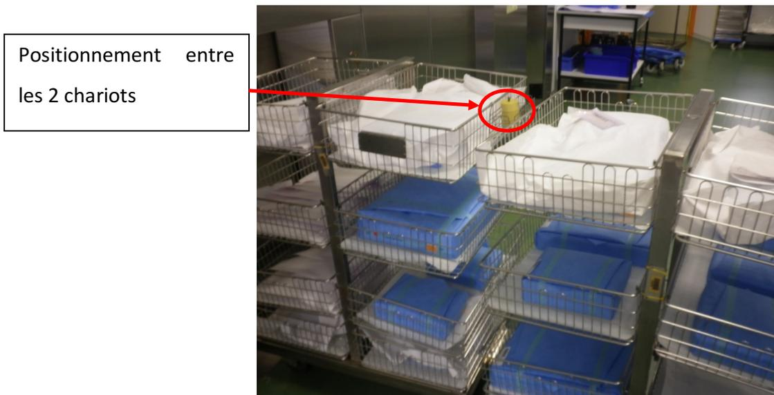
Figure 27: Positionnement de la sonde dans l'autoclave lors d'un cycle de production
