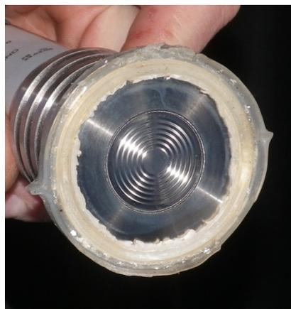
**Figure 13: Membrane d'un capteur de pression**
