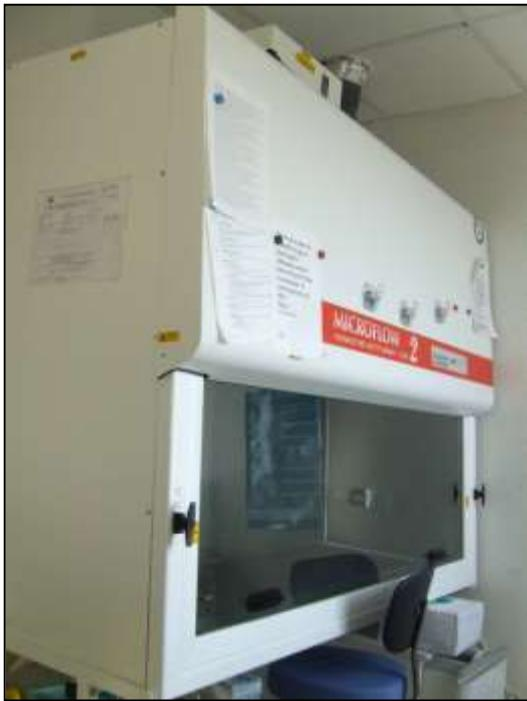
Figure 2 : Hotte à flux d'air laminaire
