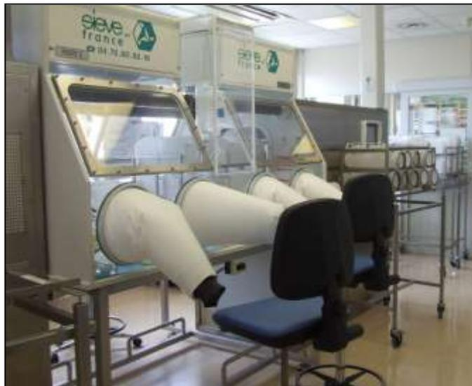
*Figure 1 : Isolateur en surpression muni de gants*
