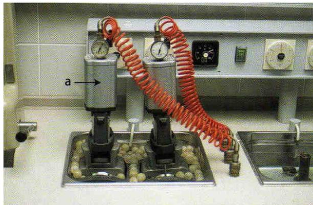
Moufle en place immergé dans l'eau à 98°, le système d'injection (a) restant hors de l'eau. (14p175)
