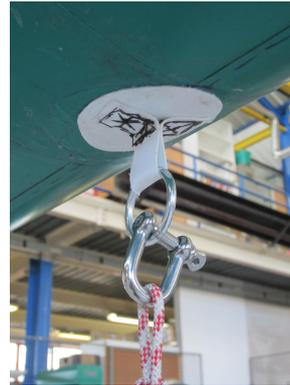
**Fig. 2.46** – Patch de fixation pour la poutre.
