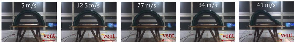
(b) Changement de la géométrie de la structure SG2-F au cours du chargement
