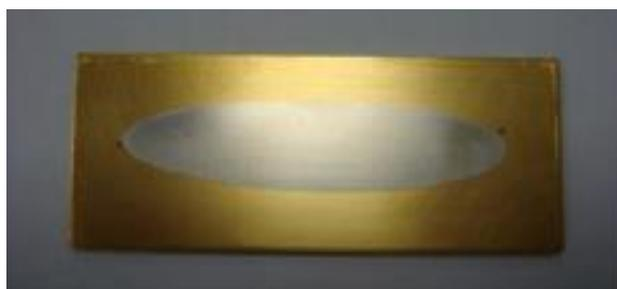
**Figure 6** : Une cible de  $^{64}\text{Ni}$  sur son support en or utilisée pour la production de  $^{64}\text{Cu}$ .
