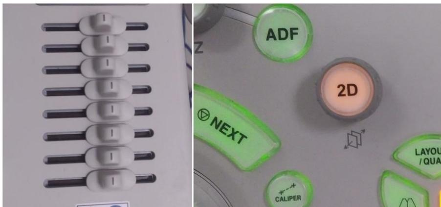
**Figure G : à gauche : réglage du gain multi étagé. A droite, réglage du gain simple (nommé « 2D » sur cet appareil)**
