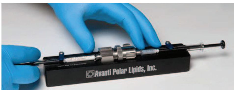
Figure 16 : Technique d'extrusion sur membrane de polycarbonate employant le Mini-extruder TM (Avanti ® Polar Lipids)
