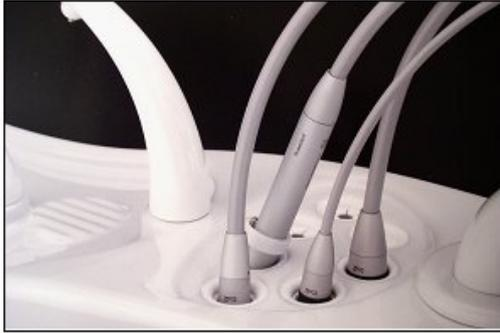
Figure 27 : système de désinfection intégré à l'unité Puma Evo de Castellini.
