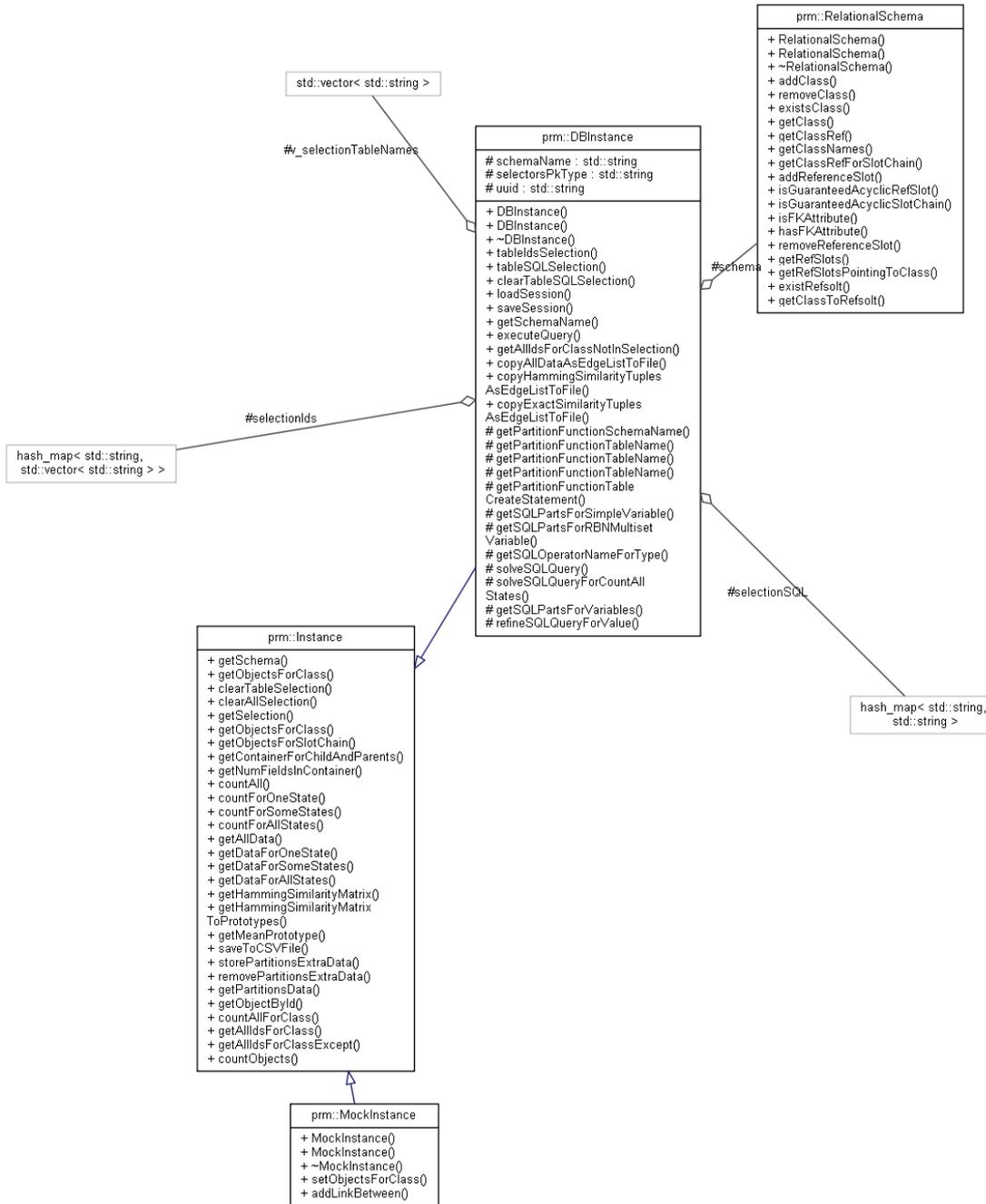
FIGURE 7.5 – Diagramme de classe simplifié du composant instance
