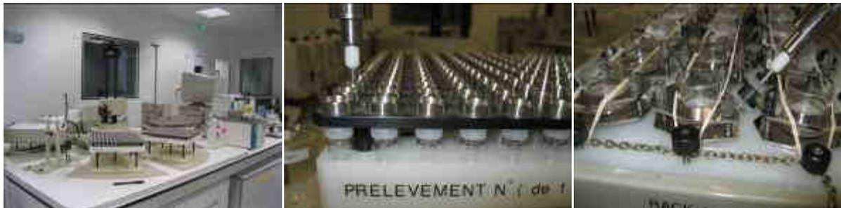
La suite de l'essai est réalisée automatiquement par le robot : prélèvements aux temps indiqués et transfert en vial, prêts à être dosés par HPLC.
