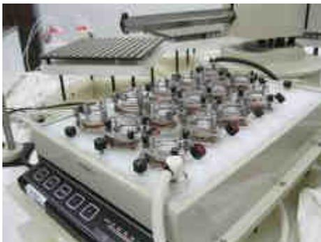
Les cellules prêtes sont mises 1h à conditionner en température sur le rack thermostaté à 34°C, pour atteindre une température à la surface de la peau équilibrée à 32°C.
