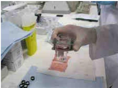
Elle est ensuite placée entre les compartiments donneur et receveur. L'ensemble est fixé à l'aide d'un système adapté. Le milieu receveur est rempli à l'aide d'une seringue.
