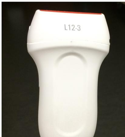
FIG. 9 - Sonde linéaire haute fréquence.
