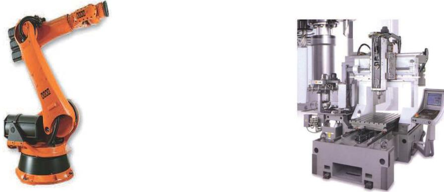
figure 1.2: Exemples de robots anthropomorphes (à gauche) et cartésiens (à droite)
