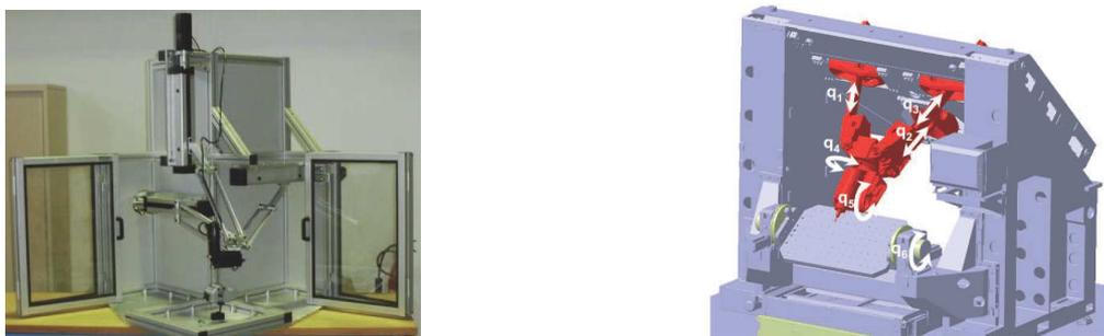
figure 1.3: Exemple de robots parallèles (L'Orthoglide développé à l'IRCCyN à gauche, et le PCI Tripteor X7 utilisé à l'IFMA à droite)
