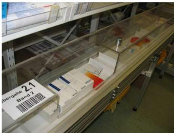
**Figure 27: Ouverture en plexiglas sur la couverture du tapis roulant : Zone de dépôt de la cueillette**
