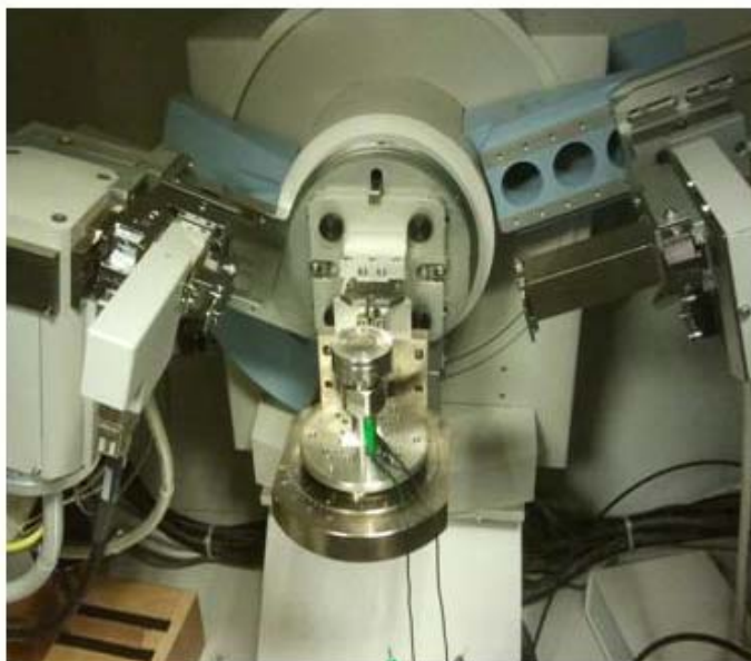
Figure 83 : Cliché du dispositif utilisé afin d'obtenir des diffractogrammes de rayons X durant le cyclage du matériau.
