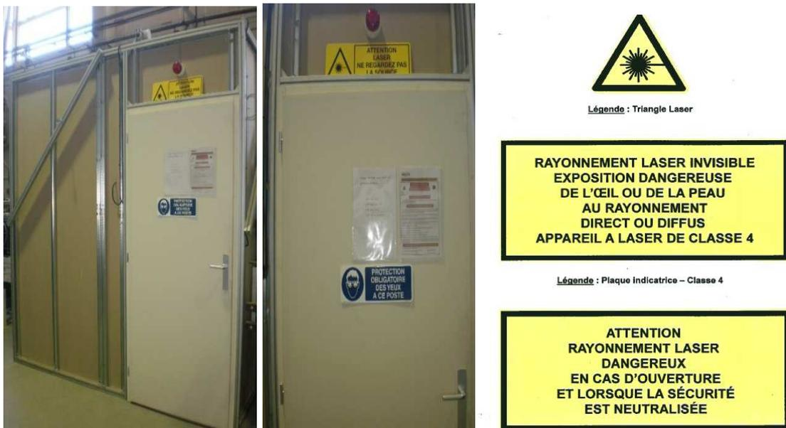
Figure 2.39. Confinement du système laser et PIV avec le dispositif de mesures dans le local fermé (respect des normes de sécurité)
