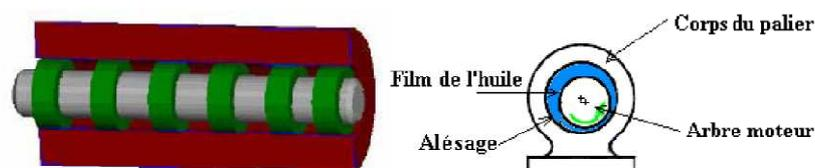
a) Palier constitué de deux cylindres coaxiaux à plusieurs roulements b) Palier en phase de démarrage
