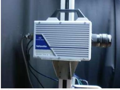
Figure 2.36. Caméra rapide utilisée (La Vision utilisé)
