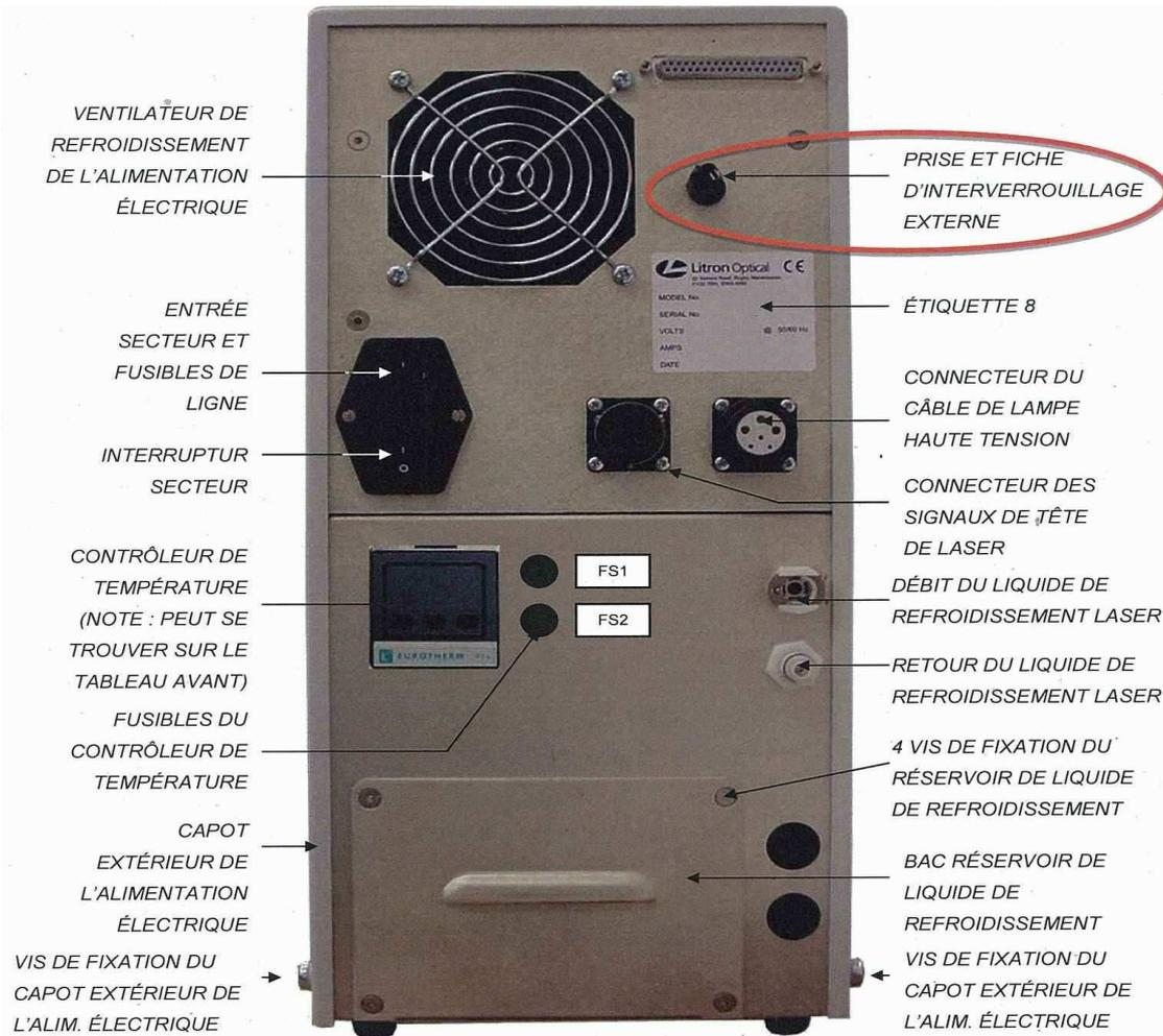
Figure 2.38. Principe de sécurité laser sur le panneau arrière de l'alimentation électrique
