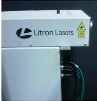
Figure 2.33. Laser Nd-YAG pulsé utilisé (La Vision)
