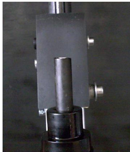
Fig. 2.7. Plaque insérée dans le système de chauffage résistif : vue de côté et de haut.
