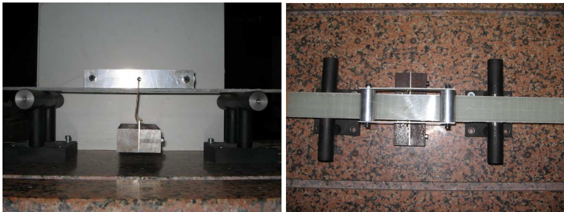
(a) Montage de flexion quatre points vu de profil. (b) Montage de flexion quatre points vu de dessus.
