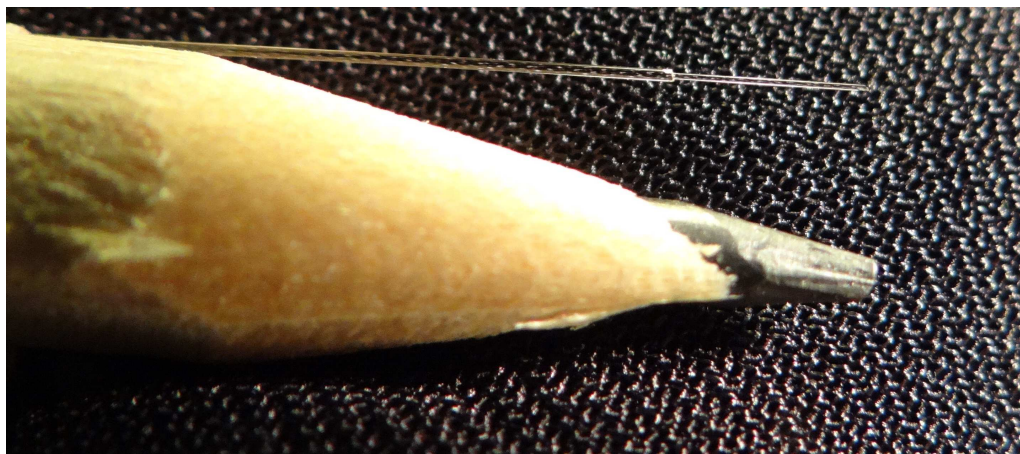
FIGURE 1 – Fibre optique au dessus d'une mine de crayon.
