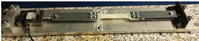
FIGURE 4.14 – Photographie de montage de traction.
