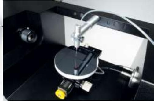
Photographies 8a et 8b : DIGIDROP (produit GBX, modèle d'angle de contact assisté par analyse d'image relié à un ordinateur (Silicon Graphic))
