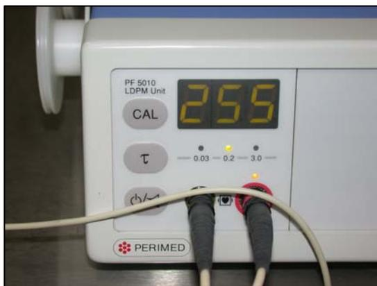
**Figure 27 : Fin de la procédure de calibrage. La valeur de la solution fournie par PERIMED est de 250 ( $\pm 15$ ) PU.**
