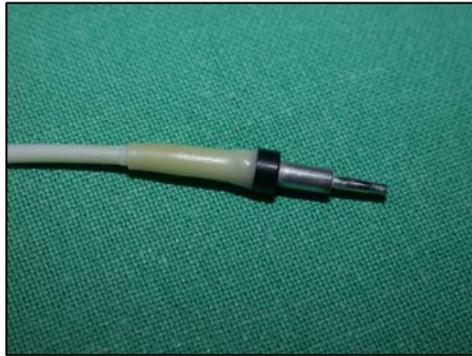
**Figure 24 : Extrémité métallique de la sonde optique : modèle 407-2 (PERIMED, Suède).**
