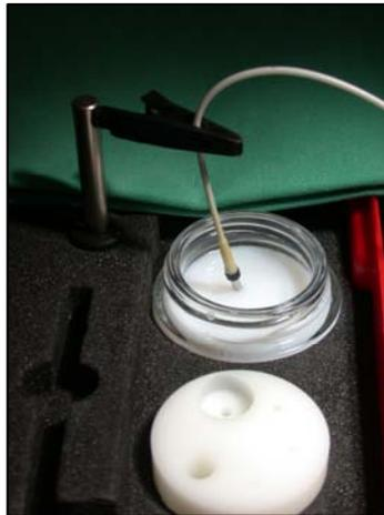
**Figure 25 : Solution de calibration du fluxmètre laser Doppler.**
