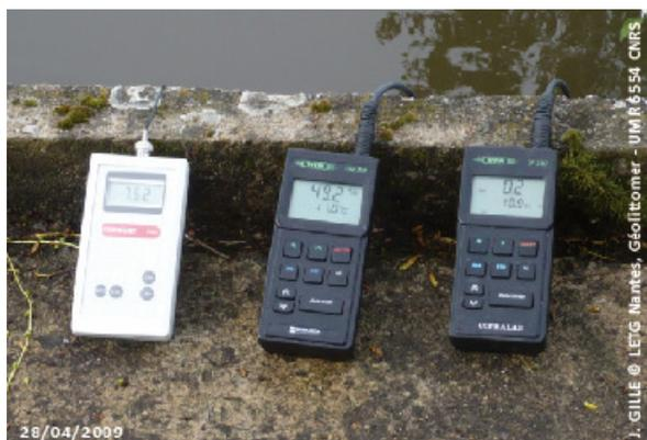
Photographie C-1 : Sondes utilisées pour la mesure des paramètres physico-chimiques
