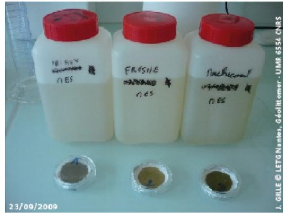
Photographie C-4 : Echantillons prélevés et filtres après filtration
