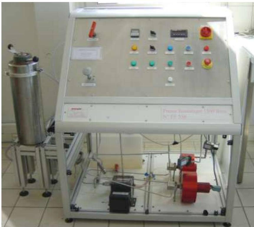
Figure 24 : presse isostatique 150MPa, N° FF558, Nova Swiss.
