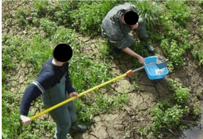
Figure I. 11 : Exemple de prélèvement d'un échantillon de sédiment avec une pelle à manche télescopique.
