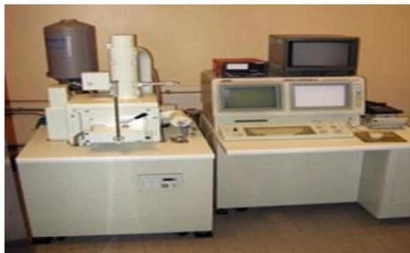
Figure II. 3 : Le Microscope électronique à balayage utilisé JSM 5800 LV SEM
