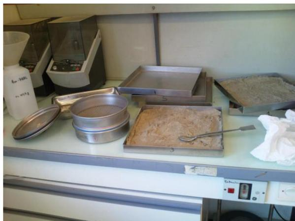
Figure II. 7 : Echantillons (Sédiments) lyophilisés passés au tamis 2 mm sous sorbonne
