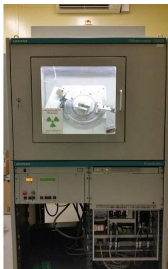
Figure II. 2 : Le diffractomètre utilisé de type D5000 SIEMENS
