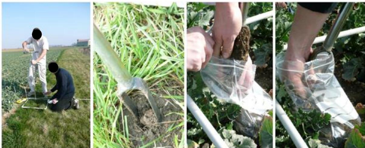
Figure I. 10 : Exemple de prélèvement d'un échantillon de sol cultivé avec une tarière (Viollet et al, 2015).
