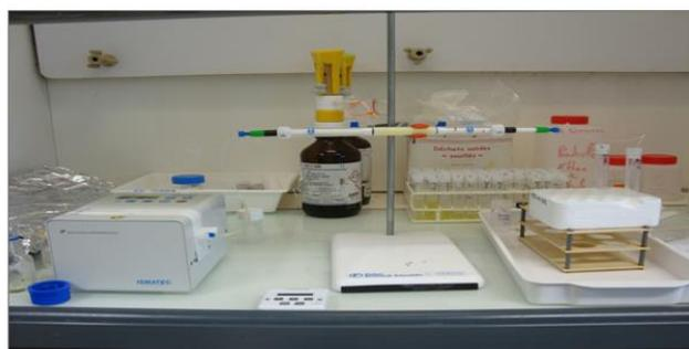
Figure II. 12 : Schéma expérimental du montage de la séparation d'Am et Pu
