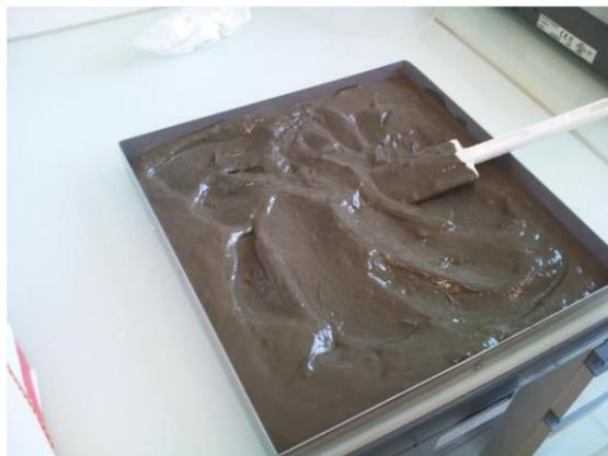
Figure II. 5 : Echantillon (sédiment) frais placé dans un des plateaux de lyophilisation
