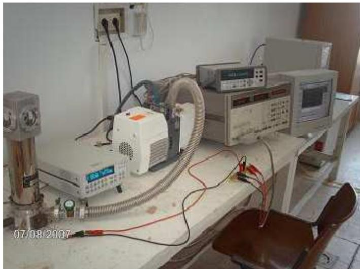
**Figure II-9 :** Montage utilisé pour les mesures d'impédance complexe à basses températures
