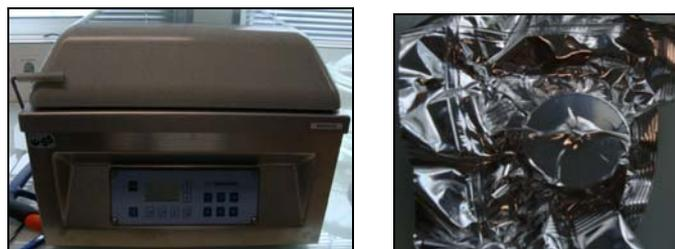
*Figure 15 : Machine à cloche pour la conservation des carottes d'argilites.*
