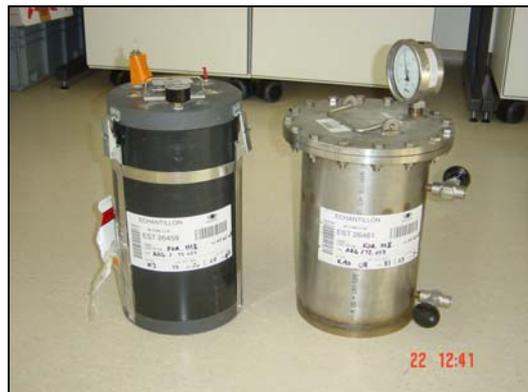
*Figure 14 : Différents conteneurs utilisés pour le transport des échantillons d'argilites.*
