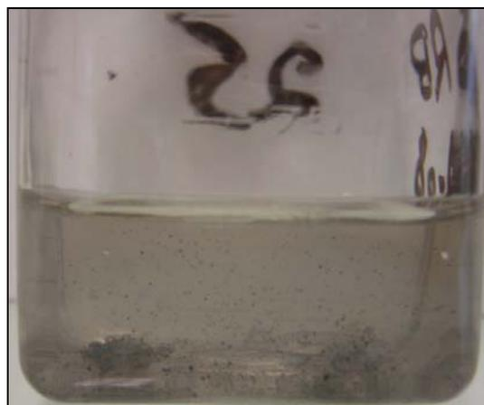
Figure 26 : précipité noir formé au cours de la croissance des BSR dans le milieu d'enrichissement ainsi que dans l'eau de COX synthétique.
