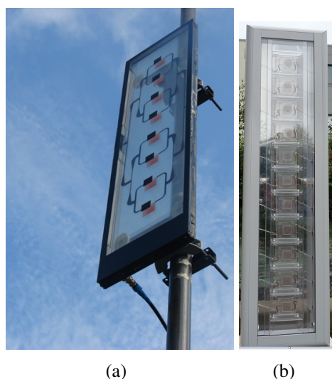
FIGURE 1.31 : Résultats des travaux de J. HAUTCOEUR [35] et P.A. GARCIA [36], (a) antenne transparente en verre fabriquée par Saint Gobain , antenne en plexiglass fabriquée par RFS (b)
