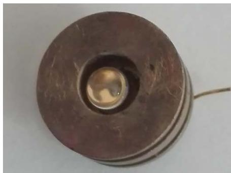
Figure III.1 : Plot XPS percé avec une diode centrale utilisé pour les mesures sous illumination
