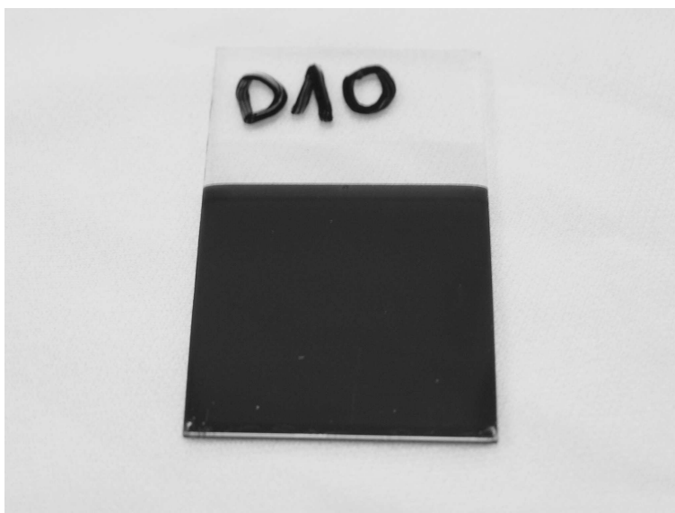
FIG. 4.8 – Photo d'une couche mince de PIII réalisée par dip-coating
