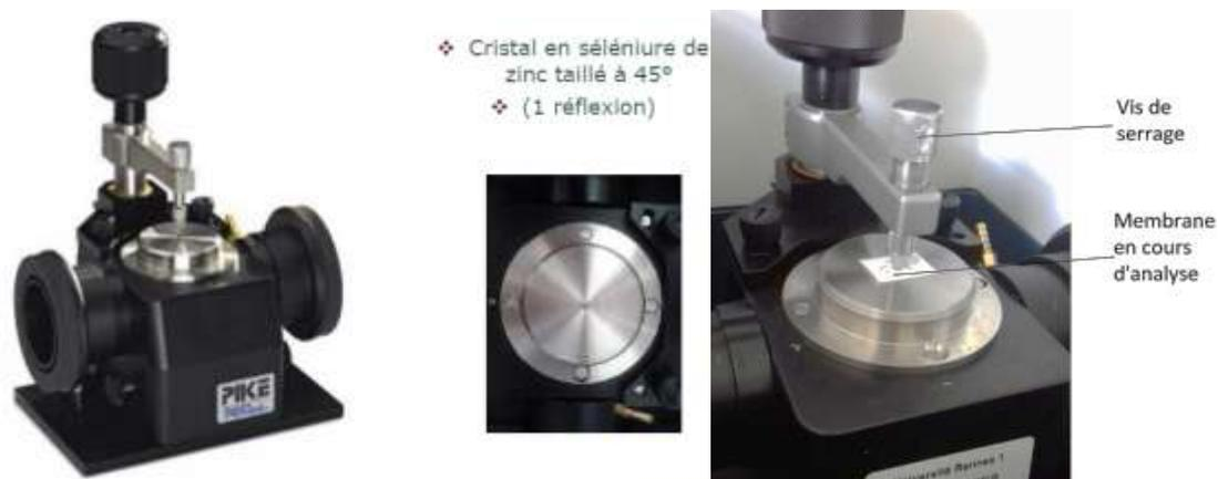
Figure II.14. Photos de l'accessoire MIRacle™ (PIKE) sur le spectromètre Jasco 4100 FT/IR.
