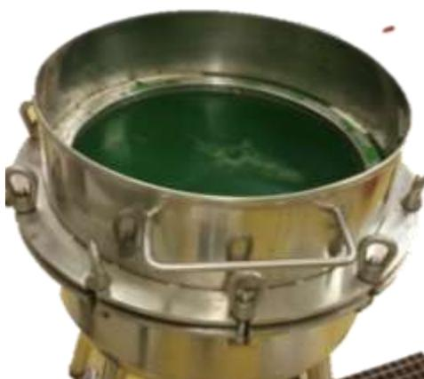
Figure III.4. Filtration sur Büchner avec une toile en nylon de 5  $\mu\text{m}$ .
