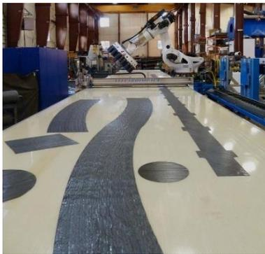
Figure 2.14 Contours complexes en composites
