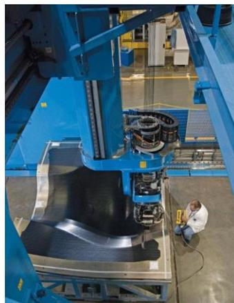
*Figure 2.13 Robot utilisée dans l'ATL (Sloan, 2008)*
