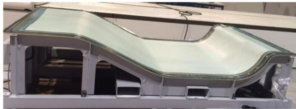
*Figure 2.12 Moule ouvert pour dépôt des fibres*
