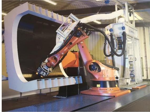
Figure 2.17 Robot utilisé dans l'AFP (Coriolis-Composites, 2016)
