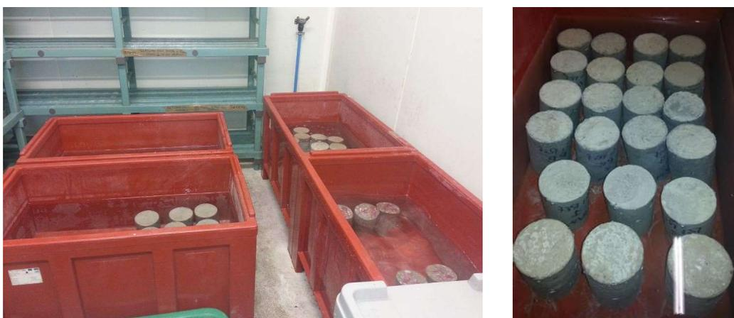
**Figure 2-20** : Illustration de la conservation des éprouvettes de bétons une salle régulée en température à  $20\pm 2^\circ\text{C}$  et humidité à 90%
