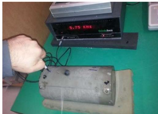
**Figure 2-23 :** Illustration de la mesure du module d'Young par le Grindosonic®
