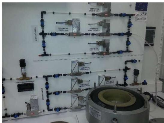
**Figure 2-27** : Perméamètre au gaz « CEMBUREAU »
