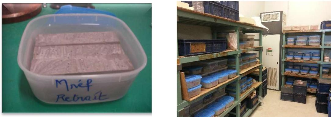
**Figure 2-19** : Conditions de conservation des éprouvettes de mortiers en salle régulée en température à  $20\pm 2^\circ\text{C}$
