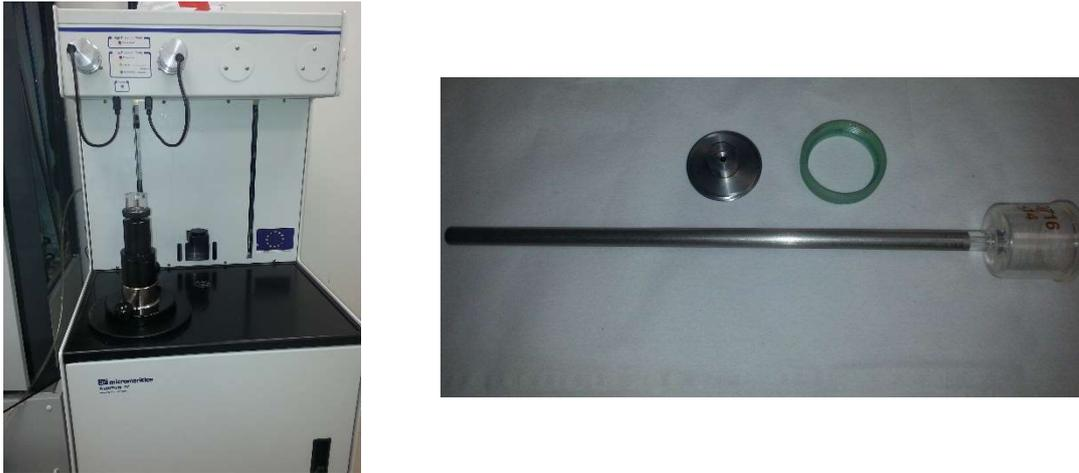
**Figure 2-26** : Porosimètre Micromeritics Autopore 9500 series IV et pénétromètre
