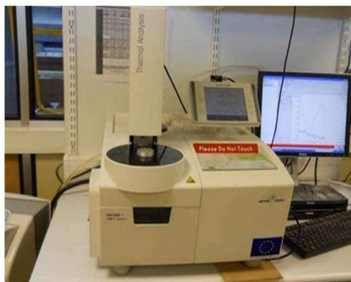
**Figure 2-29** : Appareil d'analyse thermo gravimétrique (ATG).
