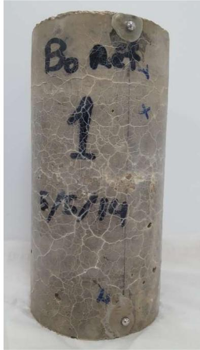
**Figure 3-5:** Fissuration du béton Ba avec déclenchement de la RSI.
