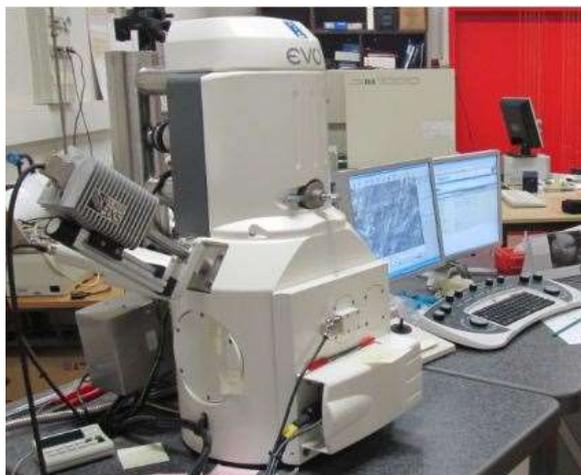
Figure 2-28 : Microscope électronique à balayage ZEISS EVO®40
