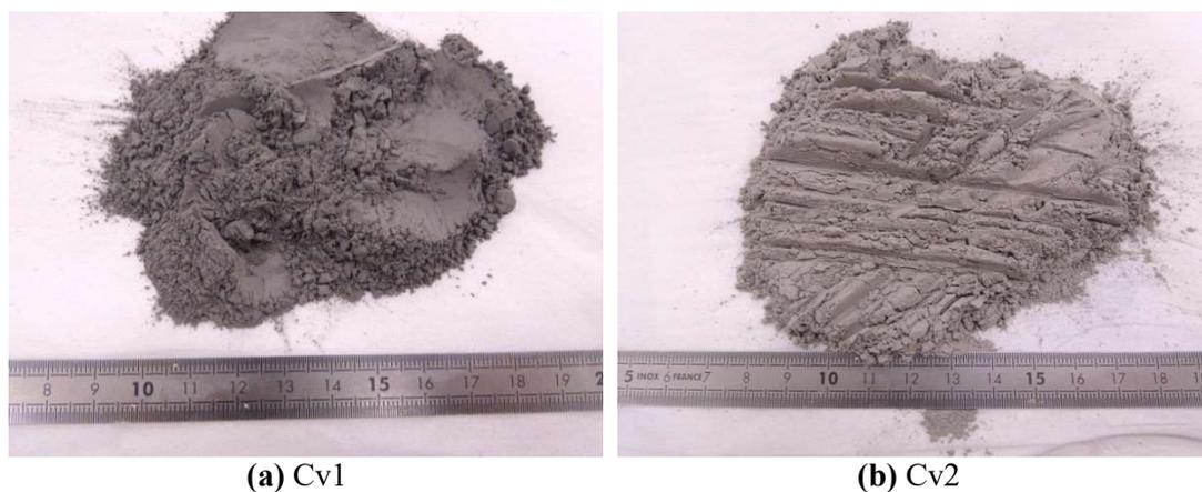
**Figure 2-9 :** Poudres de Cendres volantes : (a) Cv1 et (b) Cv2
