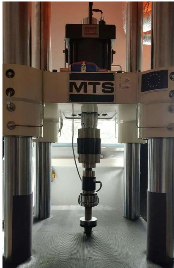
**Figure 2-25** : Presse pour les essais de compression sur éprouvettes de béton ( $\varnothing=110 \text{ mm}$  x  $H=220 \text{ mm}$ )
