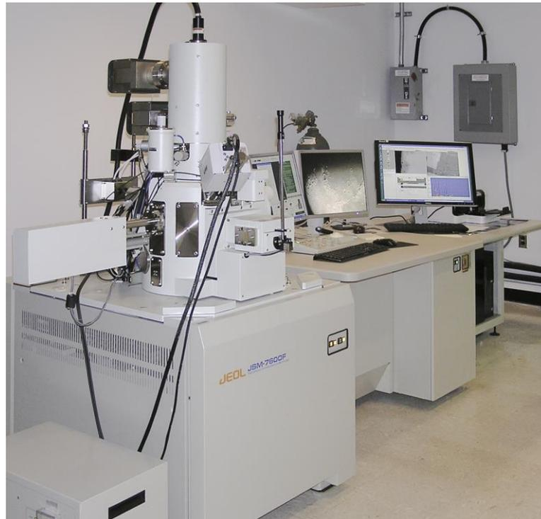
**Figure I. 14 : Microscope Electronique à Balayage JEOL 7600F**
