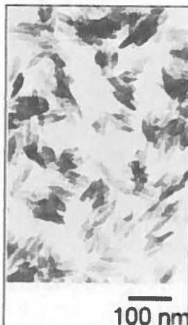
Figure 31 : Dioxyde de titane en microscopie électronique en transmission [132]
