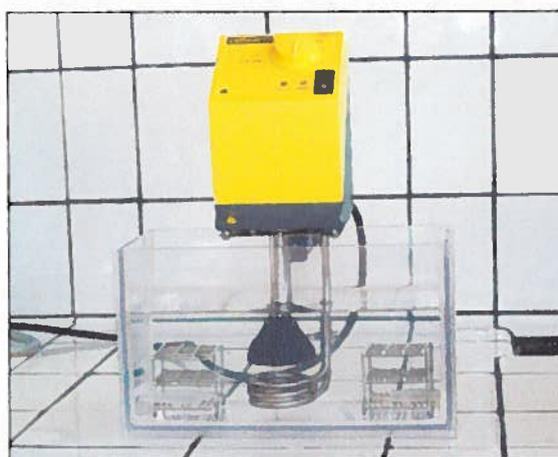
Figure 65 : Système expérimental de détermination *in vitro* du caractère de résistance à l'eau d'un produit solaire utilisé au LPIC
