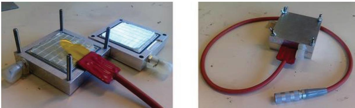
*Figure III- 29 : Montage expérimental permettant l'injection d'un fluide autour de la sonde Hot Disk. A gauche, les deux demi-moules et leur renfort avec la sonde. A droite, le moule fermé que l'on plonge dans le bain d'un thermorégulateur.*
