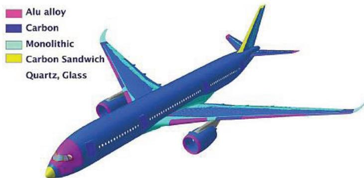
Figure II- 2 : Part des matériaux composites dans l'Airbus A350 (Source : Airbus)
