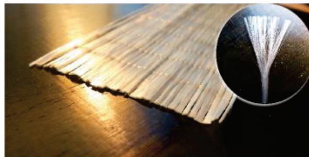
Figure IV- 24 : Prise de vue d'un pli de renfort de verre et gros plan sur une mèche le constituant.
