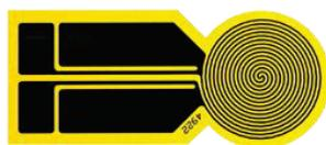
*Figure III- 6 : Vue détaillée d'une sonde Hot Disk en Kapton™*
