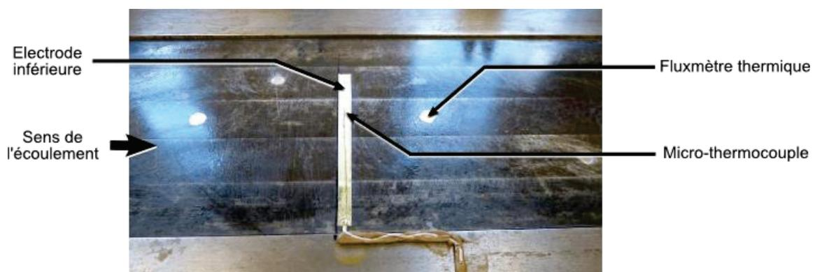
Figure IV- 22 : Positionnement et instrumentation de l'électrode conductimétrique inférieure
