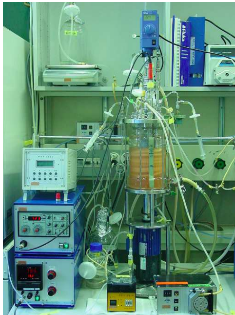
Figure 17 : Culture de cellules mammifères effectuée dans un bioréacteur de laboratoire
