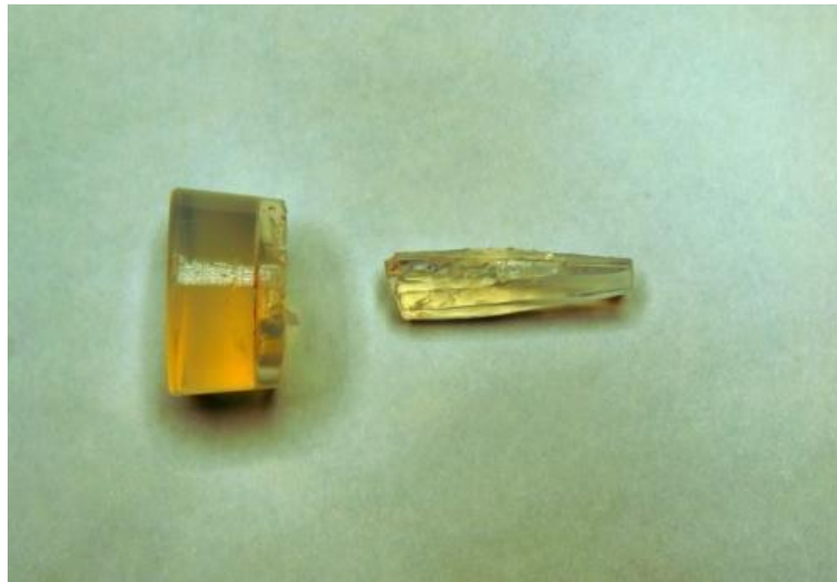
Figure 13 : Prothèse Silastic® fracturée et retirée
