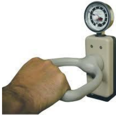
Figure 23 : Dynamomètre hydraulique de torsion
