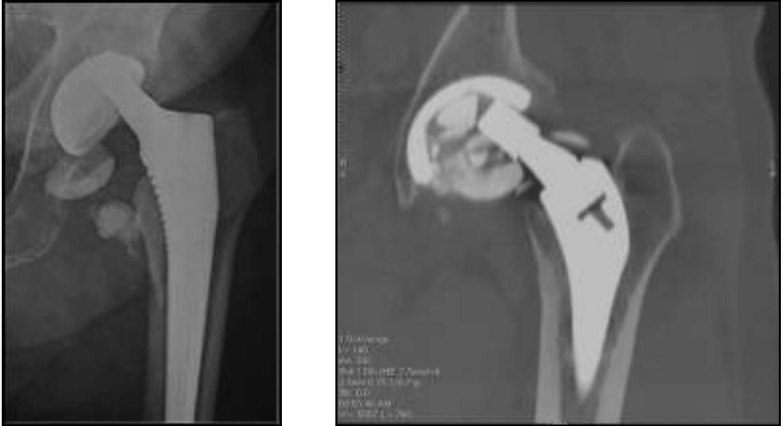
**Fig 9. Radiographie et scanner d'une rupture de tête céramique.**
