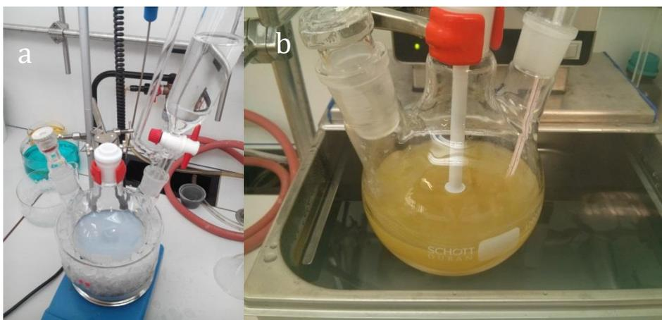
**Figure 23 :** Montages expérimentaux utilisés pour la préparation de NCC par hydrolyse acide à l'acide sulfurique de linters de coton. a) Incorporation de l'acide sulfurique dans la cellulose repulpée b) Aspect de la suspension après 20 min d'hydrolyse à 70°C.
