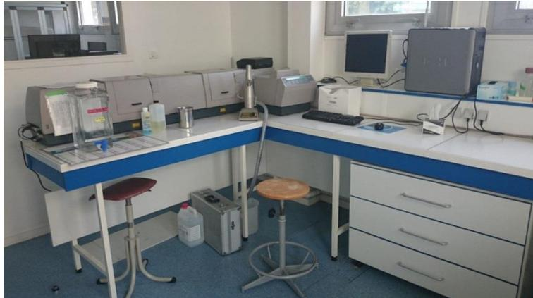
**Figure 35:** *Granulomètre laser Mastersizer de chez Malvern – INRA Nantes*
