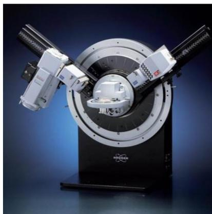
**Figure 34 :** Photographies d'un diffractomètre de laboratoire
