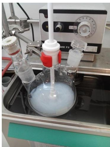
**Figure 24 :** Aspect de la suspension après 3 heures d'hydrolyse à l'acide chlorhydrique.
