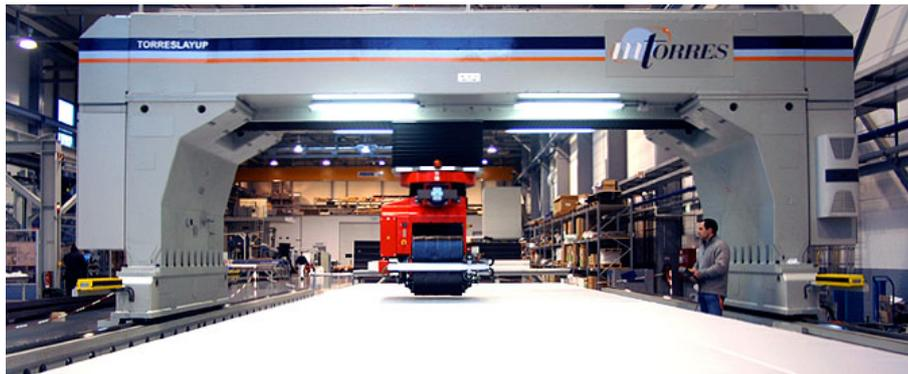
FIGURE 2.3 – Placement de bandes automatisé - Brochure commerciale MTorres [MTorres, ]
